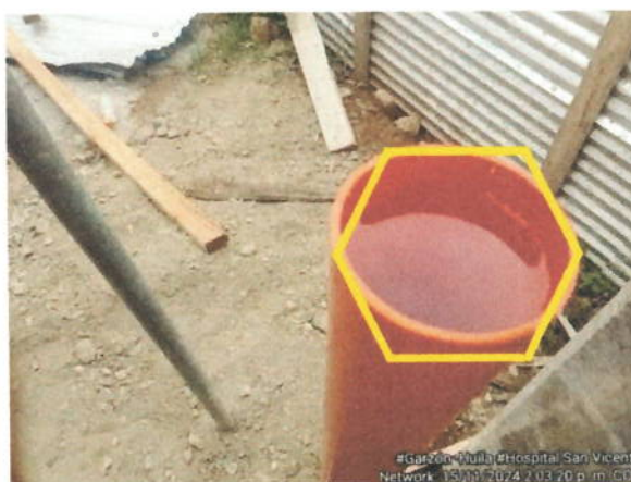
Nivel al inicio de la prueba Resultado de la primera prueba con descenso de 6 cm. (4%)
