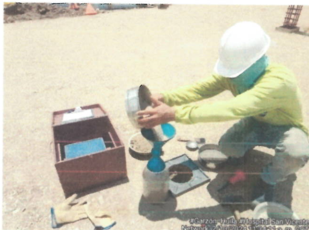
Toma de densidades con el método de cono de arena
